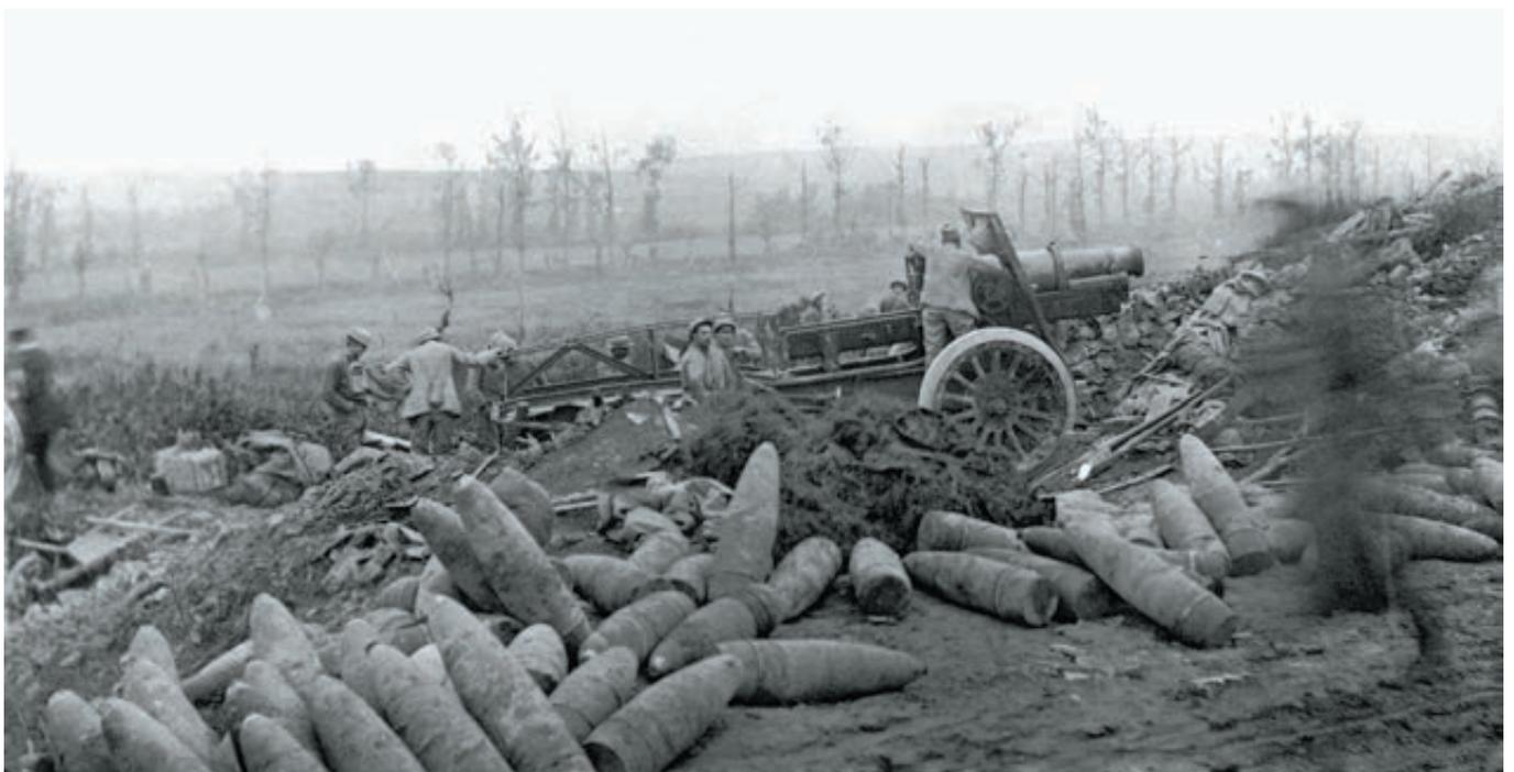
UN MORTIER DE 220 TR MODÈLE 1916 SCHNEIDER EN POSITION DE BATTERIE SUR LES ARRIÈRES IMMÉDIATS D'UN SECTEUR DU FRONT TENU PAR LES AMÉRICAINS, EN 1918. LA PIÈCE EST EN POSITION DE CHARGEMENT, TUBE DANS L'AXE DE LA RAMPE SURÉLEVÉE MODÈLE 1918 QUI AIDE LES SERVANTS À MOUVOIR LES OBUS DE 100 KILOS DONT ON VOIT UN STOCK DÉSORDONNÉ AU PREMIER PLAN.
