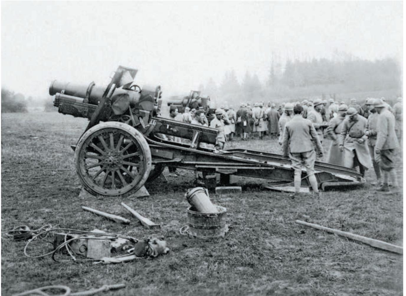
UNE SECTION DE DEUX MORTIERS DE 220 TR SCHNEIDER SUR LES ARRIÈRES DU FRONT. IL S'AGIT ICI DE MATÉRIELS MODÈLE 1916, RECONNAISSABLES À LEURS BANDAGES EN CAOUTCHOUC. LES RAILS À L'ARRIÈRE DE LA FLÈCHE SERVENT AU CHARGEMENT. UN DISPOSITIF AMOVIBLE SURÉLEVÉ SERA ADOPTÉ EN 1918 POUR RENDRE MOINS PÉNIBLE LE CHARGEMENT D'OBUS PESANT CHACUN UNE CENTAINE DE KILOS.
